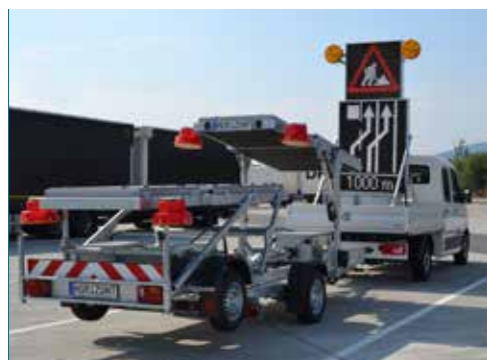
2017 Anhängergespann, das bis zu drei VWAs transportieren kann – bedient durch eine Person
