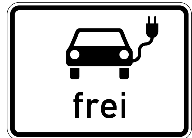
VZ 1024-20 Elektrisch betriebene Fahrzeuge frei
