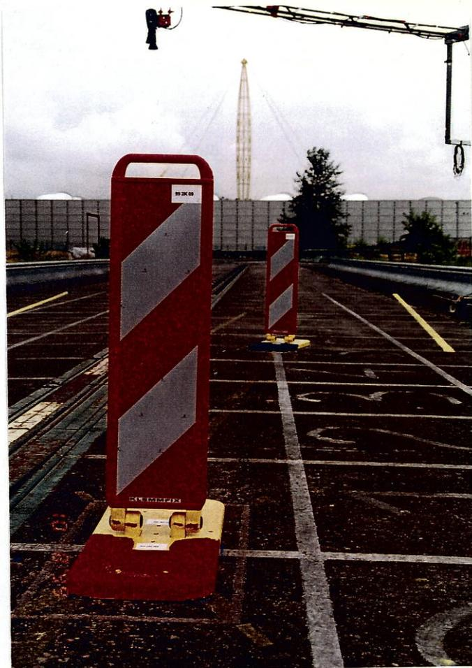
Anfahrsituation zur Prüfung der passiven Sicherheit
